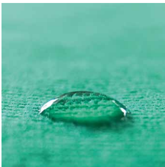
Test: Nawet jeśli kropla utrzymując się na powierzchni przyjmuje płaską formę, nasza powierzchnia tekstylna jest wystarczająco hydrofobowa, by używać standardowych folii flex.
