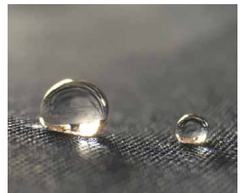
Test: Kropla jest idealnie okrągła i lekko ruchoma a gdy przechylimy powierzchnię tekstyliów, kropla przemieszcza się tocząc się po jej powierzchni. W tym przypadku transfer nie jest wskazany. Lepiej wybierzmy inną technikę zdobienia, na przykład druk albo haft.
