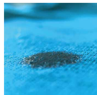
Test: Jeżeli kropla wody po krótkim czasie wniknie w materiał tekstylny, mamy do czynienia z włóknem hydrofilowym. Mogą Państwo zatem pracować ze standardowymi foliami jak np. „FlexCut Advance”
