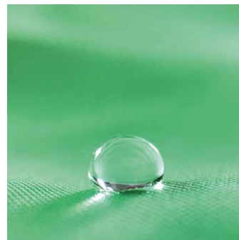
Test: Jeżeli natomiast kropla jest ewidentnie okrągła, należy koniecznie użyć folii z klejem poliamidowym, czyli na przykład „FlexCut Nylon”.
